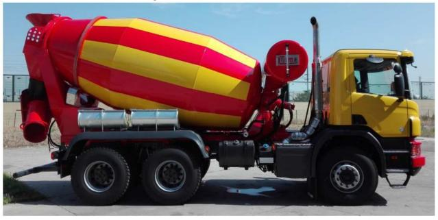
Le betoniere COIME sono disegnate con una linea moderna e compatta . Per veicoli a 3 assi, cabina tipo corto, passo minimo 3200 mm. (dal 1º al 3º asse).
