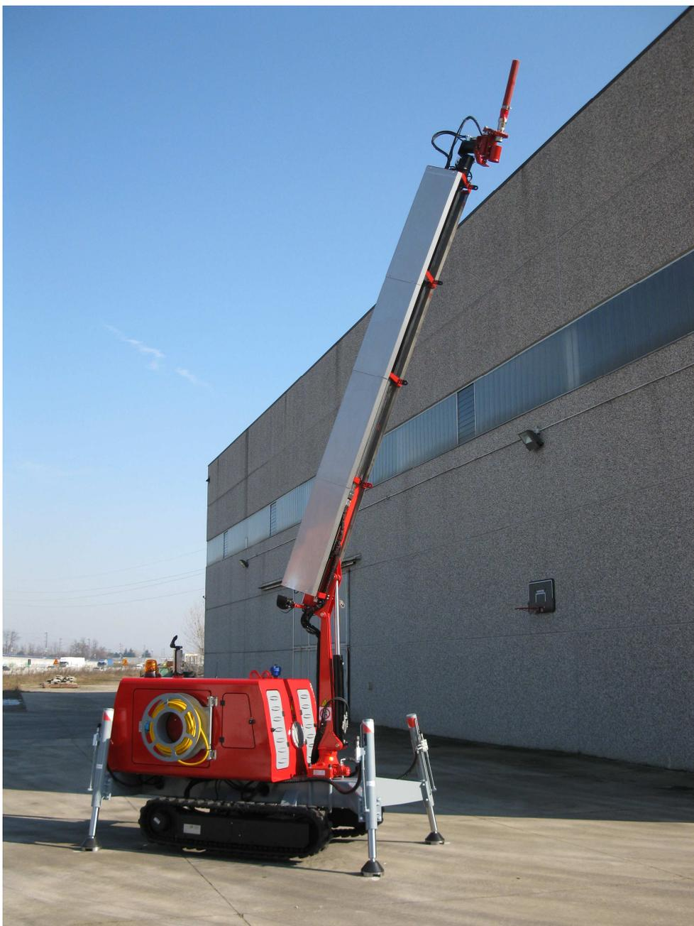
Braccio manipolatore cingolato con motorizzazione elettrica e diesel estremamente versatile da abbinare a pompa calcestruzzo dotata di sistema di dosaggio additivo per tutti i lavori di spritz beton in tunnel, miniera ed all'aperto.
